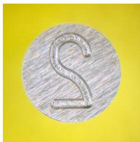
写真 1-a 3 エジクタピン先端への彫刻機による文字の凹加工
