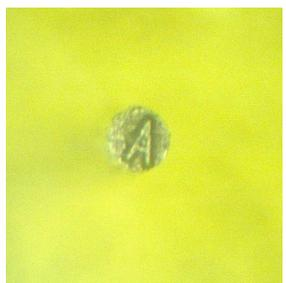
写真 1-c 0.3 エジクタピンへの文字加工。
