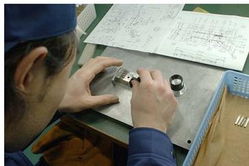
写真 6 V33 で加工した金型部品の組立て。
